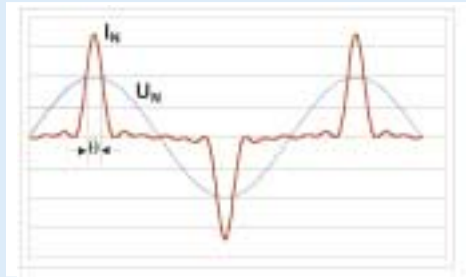
Abb. 2: Abweichung der tatsächlichen Stromkurve von der idealen Sinuskurve
